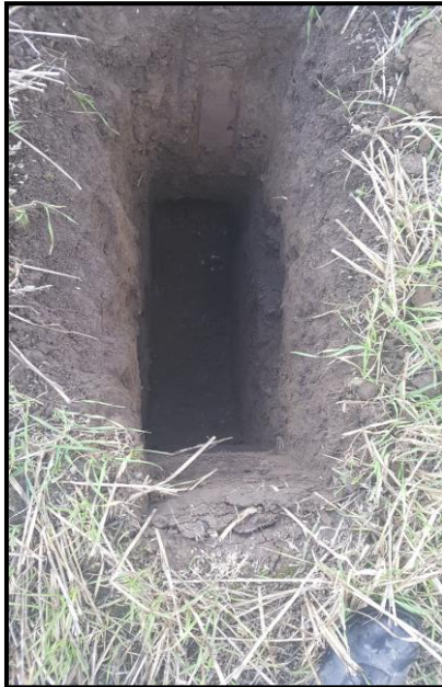
BRE 365 TEST HOLE
